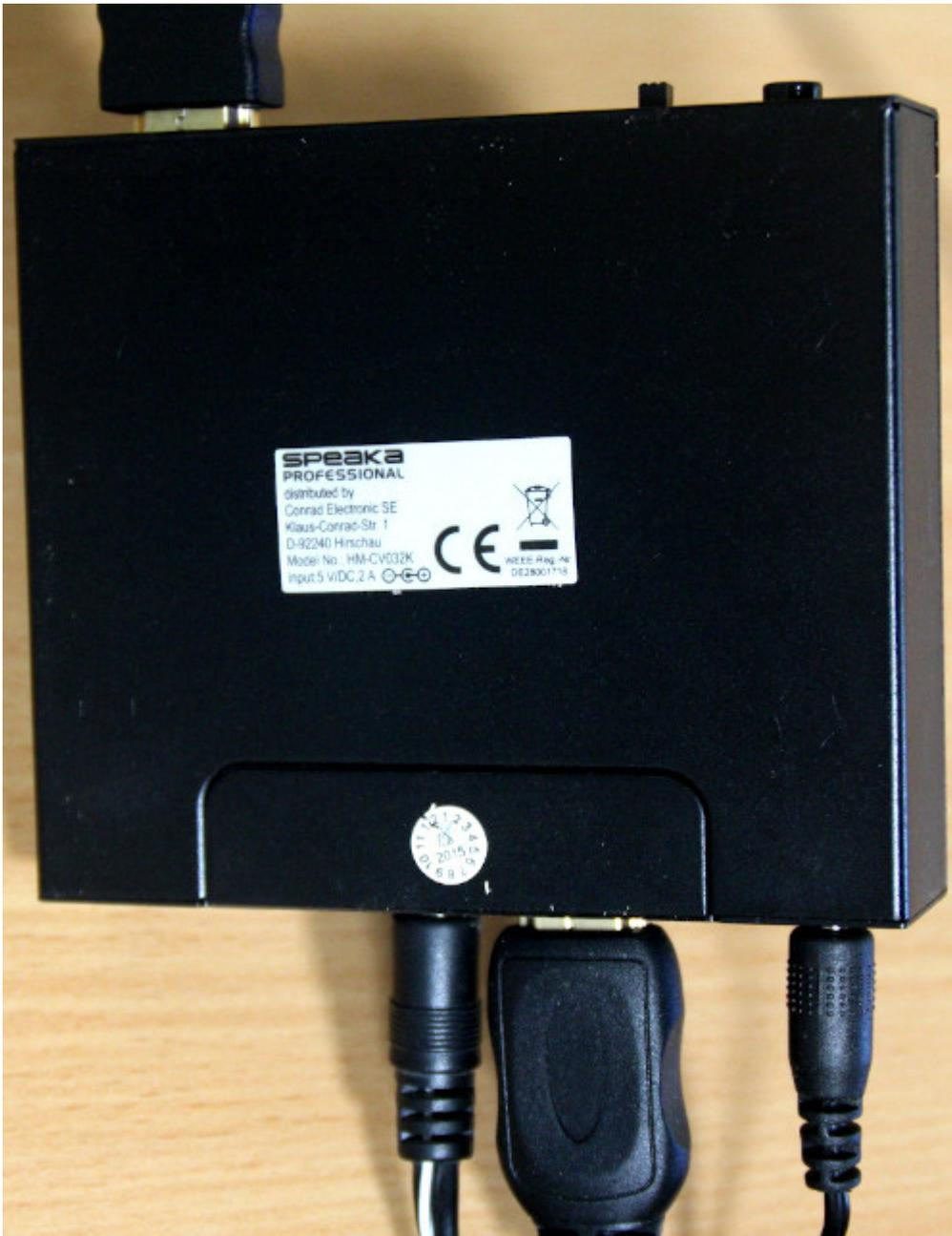
Wenn man den Ton der Kamera nicht verwenden möchte, ist auf jeden Fall das Einfügen des Audiosignals **vor** dem Encoder notwendig, um die Synchronität von Bild und Ton beizubehalten. Software-seitig (im OBS-Studio) könnte man auch noch Tonspuren einfügen, die würden dann aber im fertigen Stream zeitversetzt vor dem Bild laufen, weil der Encoder den HDMI-Datenstrom leicht verzögert ausgibt.
